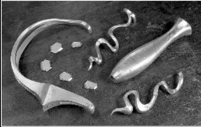
Divers éléments, avant montage de la garde de l'épée de Pierre Sinay, membre de l'Académie des sciences depuis 2005. Les hexagones sont découpés dans une plaque d'argent, puis façonnés à la lime et aux ciselets. Les autres parties attendent d'être ciselées ou polies. (crédit photos : G. Estrade)
